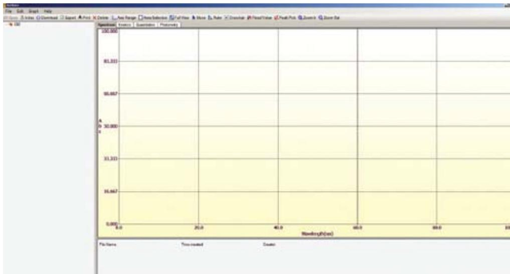
[01] Una vez se han realizado y guardado en la memoria del equipo todos los análisis y medidas requeridas, el espectrofotómetro puede ser conectado al software C30 Data Viewer vía USB para transferir todos los datos obtenidos en los distintos espacios de trabajo.
