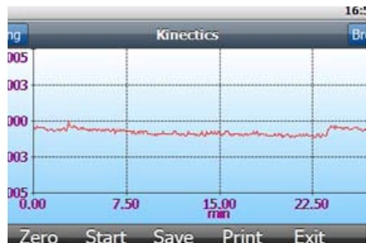
[04] El espacio de trabajo **Kinetic** permite la medida de Absorbancia o Transmitancia en función del tiempo. Utilice las funciones de zoom y “peak pick” para obtener una mejor visualización de la curva de cinética. Los datos pueden ser guardados y recuperados cuando sea necesario.
